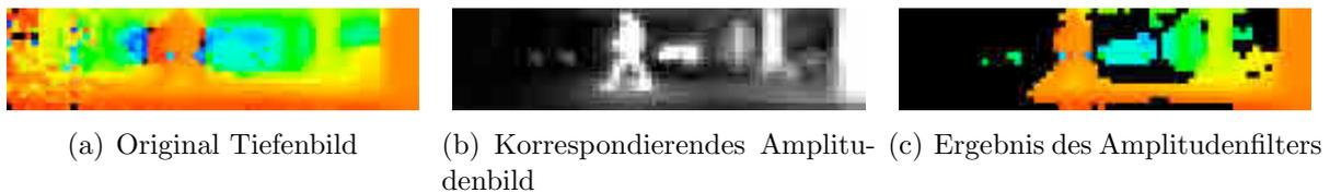
Abbildung 3.45: Effekt des Amplitudenfilters zur Demaskierung ungültiger Messwerte.
