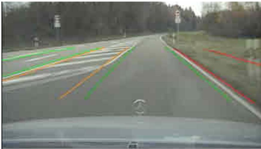
Abbildung 3.23: Überlagerung zweier Fahrspuren am Ende einer Kreuzung.
