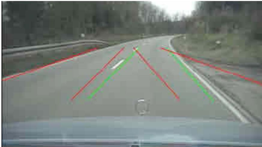
Abbildung 3.22: Ausgehend von der eigenen Fahrspur werden neue Fahrspurerkennung rechts und links daneben gestartet.
