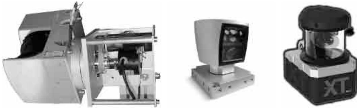
(a) Rotating Sick Laserscanner (aus [Walther 06]). (b) HD-Lidar Sensor der Firma Velodyne (Bildquelle: Velodyne). (c) Alasca-XT Sensor der Firma IBEO (Bildquelle: IBEO).
