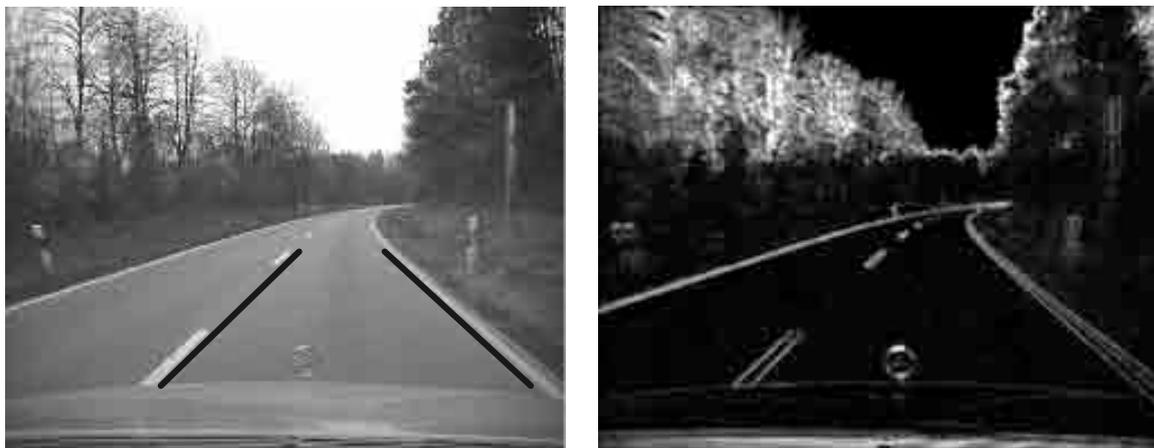
(a) Die ausgewerteten Regionen zur Bestimmung des Hinweises „Straßenkante“. (b) Das mit einem Canny-Kantendetektor gefilterte und geglättete Bild zur Detektion der Straßenränder.
