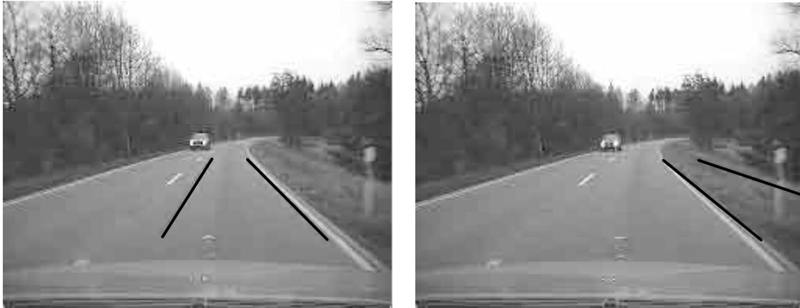
(a) Zu schmal geschätzte Fahrspur aufgrund starker Markierung auf der rechten Fahrspurseite. (b) Falsch positionierte Fahrspur aufgrund starker Markierung auf der rechten Fahrspurseite.
