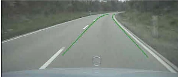
Abbildung 3.21: Darstellung des Ergebnisses der Krümmungsschätzung als eingeblendete Klothoide.
