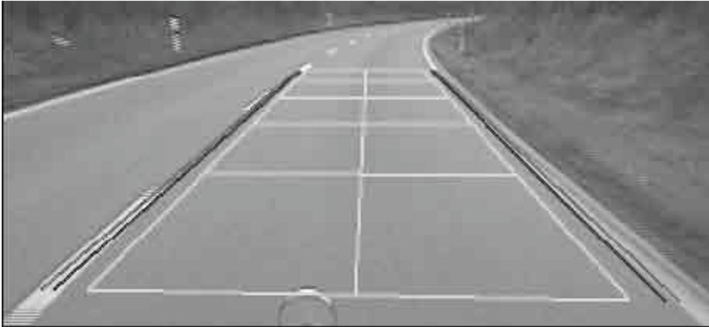
Abbildung 3.12: Projiziertes Fahrspurmodell mit eingezeichneten Regionen zur Auswertung einzelner Hinweise.
