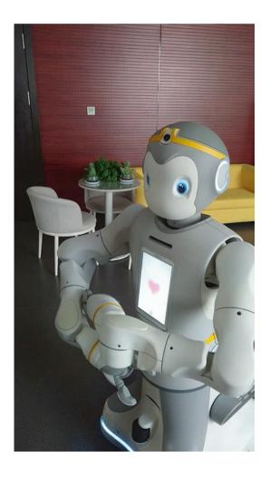
mit zwei Armen gleichzeitig arbeiten, hat ein integriertes Tablet zur Darstellung seines Zustandes sowie Mikrofon und Lautsprecher für die verbale Kommunikation.
