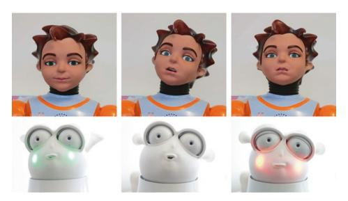
**Abb. 4.2** Emotionale Mimik bei Hanson RoboKind R50 (oben) und Robopec Reeti (unten)
