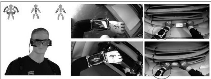
**Abb. 8:** Visuelle und taktile Rückmeldesysteme zur Assistenz von Personen; links visuelle Rückmeldung mit einer AR-Datenbrille; rechts haptische Rückmeldung mithilfe eines Mobiltelefons (nach Burkhardt 2019)
