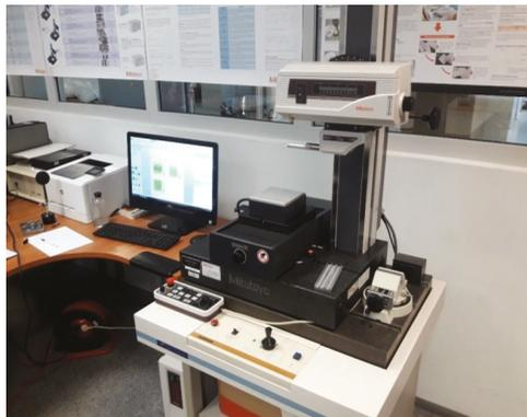
**Figure 4.** Mitutoyo profilografometer SURFTEST SV-3200.
